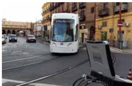
Rilevazione del "disturbo" vibrazionale al passaggio del tram
