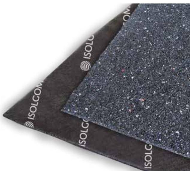
La linea **SYLPRO AD** è una membrana di protezione per l'edilizia composta da granuli di gomma SBR ancorati e pressati a caldo con leganti poliuretatici, si presta alle più svariate applicazioni come membrana protettiva ed anti-abrasione. Sylpro AD risulta un prodotto drenante e resistente al ghiaccio che consente una stabilità delle prestazioni nel tempo. Il materassino può essere facilmente applicato direttamente sopra la guaina bituminosa.
