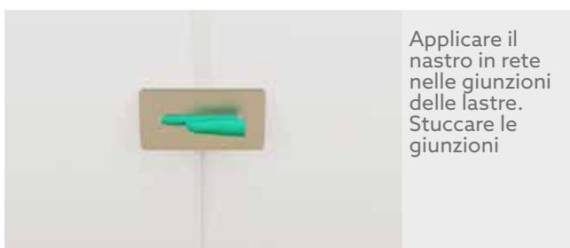
Applicare il nastro in rete nelle giunzioni delle lastre. Stuccare le giunzioni
