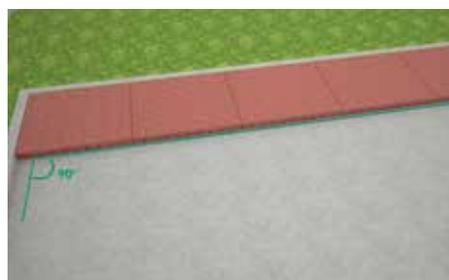
Installare la prima fila di piastre fino al bordo dall'altro lato controllando il corretto allineamento e la perpendicolarità
