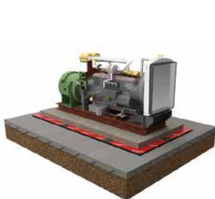
Esempio di applicazione basamento flottante. Linea MEGAMAT
